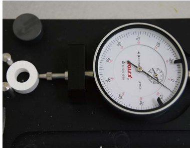
ジルコニアタブレットを焼結してその収縮率で炉内温度の差分を確認する事が出来る。
