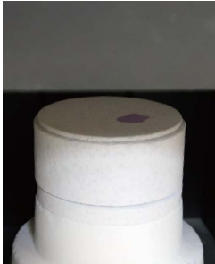
トレーの上にNacera® クリーンを10gのせ同時に焼結。これで炉内の環境を変えることができる。
