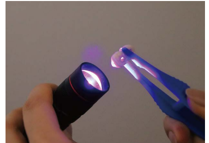
専用液に浸漬して専用ライトを照射しクラックがないか検査する。
